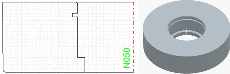
**Ejemplo:** Hombro y ranura de Anillo retenedor para montar un rodillo lateral sobre su eje
