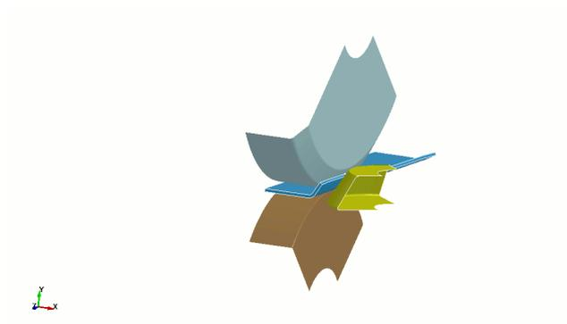
**Sólo contacto con chapa:** Sólo se muestran rodillos que estén en contacto con la chapa de una cierta estación. Esto depende de la longitud de la chapa y la distancia entre pasadas. Ventaja: La simulación es más rápida.
