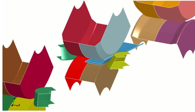
**Todos:** Se muestran todos los rodillos de toda la máquina. Si el perfil es simétrico, también se ven los rodillos del lado izquierdo, aunque no estén en contacto con la chapa. Combinado con **Ángulo Rodillo = 360°** los rodillos de la máquina completa se muestran en un estilo adecuado, útil para imágenes para folletos, etc.
