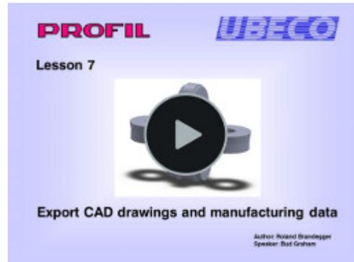
Aprenda a transferir [dibujos](#) y [modelos 3D](#) a CAD. Se muestra cómo exportar [listas de piezas](#) y listas de corte respectivamente para el corte de brutos desde la barra. Aprenda las tres opciones que hay para exportar datos para torneado: [Códigos G](#) al control del torno, [Ficheros DXF](#) a un sistema CAD/CAM, y [salida impresa](#).
