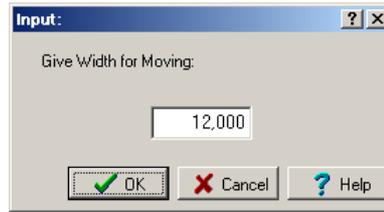
Aparece el cuadro de entrada con la pregunta **Dar distancia para mover**. Entrar el valor del movimiento. Entrar un valor positivo mueve los rodillos en la dirección del último rodillo, un valor negativo los mueve en la dirección del primer rodillo. Para obtener la cantidad a mover, es útil la función [Medir](#).
