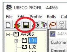
Después se pueden guardar todos los ajustes del cuadro de parámetros FEA y los datos de material en el fichero proyecto usando la función [Guardar Proyecto](#). Si más tarde se vuelve a llamar a **Salida FEA**, todos los ajustes se vuelven a mostrar y se pueden modificar fácilmente
