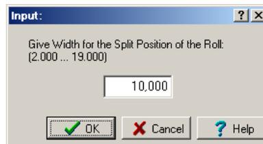
Aparece el cuadro de entrada con la pregunta **Dar Ancho para la posición de división del rodillo** y un rango admisible de valores para la entrada, que empieza al final del último empalme y acaba el principio del siguiente empalme. El ancho es relativo al [Punto Referencia Rodillo](#).
