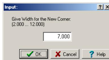
Aparece el cuadro de entrada con la pregunta **Dar ancho para la nueva esquina** y un rango de valores admisibles para la entrada, que empieza en el final del último empalme y termina en el principio del siguiente. El ancho se refiere al [Punto Referencia Rodillo](#)
