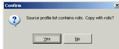
Si la pasada que se copia ya contiene rodillos, se pregunta **La lista de perfil origen contiene rodillos. ¿Copiar con ellos?** Tener en cuenta que los rodillos se reenumeran al copiarlos en otra estación dependiendo de las claves de número en [Ajustes Rodillos](#) y que los rodillos se modifican según los datos de los ejes de la nueva estación (en el [Cuadro Máquina](#)).
