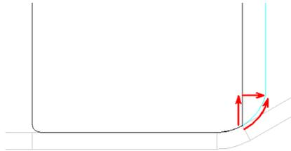
Si un rodillo tiene al inicio o al final un arco con un radio, puede ser necesario alargar el arco en vez de añadir una extensión cónica. Una razón para esto puede ser no dañar la superficie de la chapa con una esquina de rodillo. Esto significa que el centro y el radio se mantienen constantes, y el ángulo se aumenta o disminuye. La extensión puede ser negativa para tener un rodillo más pequeño. Se define la cantidad:
