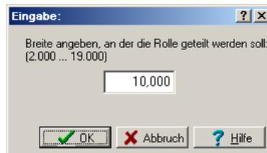
Es erscheint das Eingabefenster mit der Frage **Breite angeben, an der die Rolle geteilt werden soll** und einem zulässigen Wertebereich für die Eingabe, der zwischen dem Ende einer Rundung und dem Anfang der nächsten Rundung veränderbar ist. Die Breitenwerte beziehen sich alle auf den [Bezugspunkt](#).
