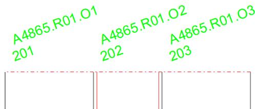
Lange [Rollennummern](#) und [Sach-Nummern](#). werden in der Zeichnung automatisch gedreht, so dass sie sich nicht gegenseitig verdecken. Wählen Sie den gewünschten Drehwinkel.
