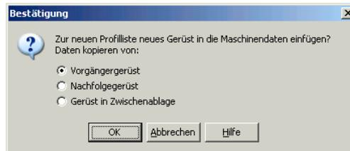
Wenn eine Profilliste angefügt wird, kann auch gleich ein passendes Gerüst in die Maschinendaten angefügt werden. Wählen Sie, ob die Daten aus dem Vorgängergerüst, dem Nachfolgergerüst oder der Zwischenablage kopiert werden sollen.
