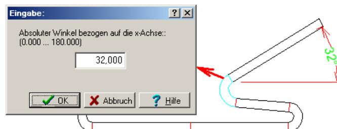
Der absolute Winkel ist der Winkel eines beliebigen [Profilelements](#) gegenüber der horizontalen x-Achse. Mit dieser Funktion können Sie sich nicht nur den absoluten Winkel an einer von Ihnen gewählten Stelle anzeigen lassen, sondern Sie können auch das Profil biegen, indem Sie einen absoluten Winkel vorgeben.
