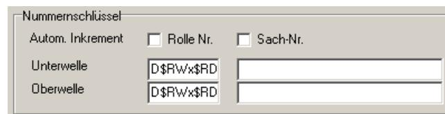
Mit diesen Voreinstellungen können Sie bestimmen, wie die Rollen- und Sachnummern bestimmt werden sollen, wenn neue Distanzrollen erzeugt werden. Wollen Sie einen geänderten Nummernschlüssel auf vorhandene Distanzrollen anwenden, benutzen Sie dazu die Funktion [Rolle Neu nummerieren](#).
