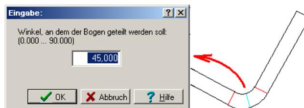
Diese Funktion teilt das markierte [Profilelement](#) von Typ Strecke (S) oder Bogen (B1..4) an einer wählbaren Position in zwei Teile.
