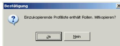
Haben Sie für den Stich, der einkopiert werden soll, bereits Rollen konstruiert, werden Sie gefragt: **Einzukopierende Profilliste enthält Rollen. Mitkopieren?**. Beachten Sie, dass beim Kopieren der Rollen in einen anderen Stich die Nummerierung der Rollen geändert wird (gemäß Nummernschlüssel in [Einstellungen Rollen](#)) und dass die Rollen gemäß Arbeitswellendaten des neuen Gerüsts im [Maschinenfenster](#) angepasst werden.
