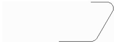
Nachdem Sie die Kontur in **PROFIL** eingelesen und am Ende der Profilliste das Element **PS** für symmetrisch angefügt haben, entsteht folgendes Profil:
