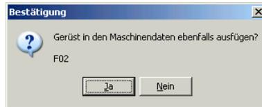
Wenn eine Profilliste ausgefügt wird, kann auch gleichzeitig das zugehörige Gerüst aus den Maschinendaten ausgefügt werden.
